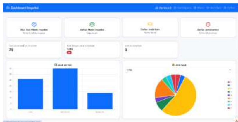
Gambar 5. Antarmuka web ( dashboard ) sistem pencatatan cacat kain berbasis IoT yang menampilkan data inspeksi secara real-time , termasuk panjang kain, jenis cacat, dan riwayat inspeksi
